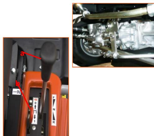
Le **régulateur de vitesse MICRODRIVE** permet par enclenchement du levier (b) de maintenir une vitesse fixe sans appuyer sur la commande d'avancement.
