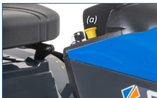
**Réglage de la hauteur de coupe par un levier à portée de main** doté d'une échelle graduée qui permet de visualiser immédiatement le niveau de la hauteur de coupe (7 positions de 3 à 8,5 cm).
