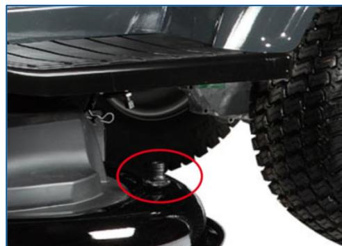
**Chargeur de batterie** (de série) pour maintenir la charge de la batterie lors du stockage hivernal : facilement accessible sans outil.
