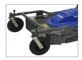
Les **roues avant sont pivotantes et verrouillables** à l'aide d'un simple loquet.
