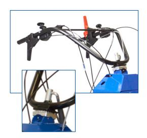
**Embrayage de la lame** commandé par un levier au guidon assurant un maximum de sécurité.
