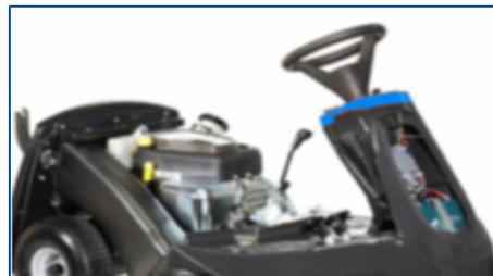
**Accès rapide au réservoir:** trappe de grande dimension à l'extérieur pour faciliter et optimiser le ravitaillement en carburant.
