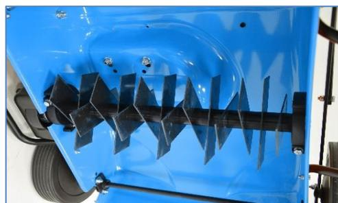
La mise en terre et le **relevage du rotor** s'effectuent à l'aide d'un **simple levier** accessible au guidon.
