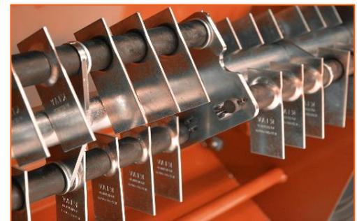
La mise en terre et le **relevage du rotor** se font à l'aide d'un **simple levier**.
