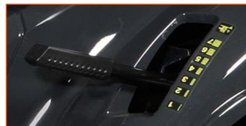
**Position de conduite confortable**, grâce au siège réglable sans outils en fonction de la taille de l'opérateur.
