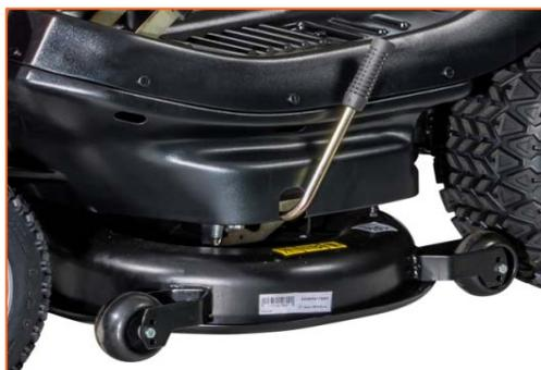
Le **raccord rapide "deck wash system"** permet de diriger l'eau directement à l'intérieur du plateau de coupe pour faciliter les opérations de nettoyage.
