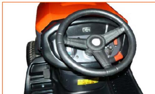
Le **système "change-Over"** permet de passer, grâce à un levier à portée de main (en remplacement du levier central) du mulching à l'éjection arrière, et inversement.
