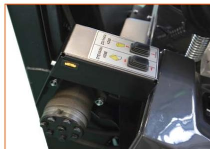
**Montée du bac** par une pompe hydraulique jusqu'à une **hauteur de 1,87m** en moins de 5 secondes.
