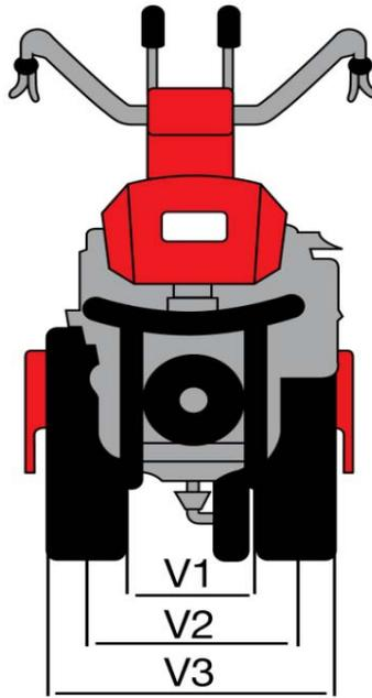
**Roues d'origine 400x8 (largeur de roue = 10 cm)**
