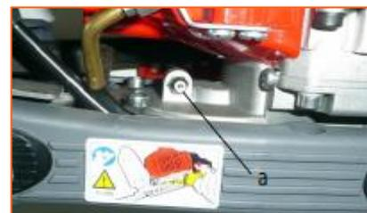
**Interrupteur on/off "Always-on"** qui retourne automatiquement sur la position de démarrage chaque fois que l'on arrête le moteur.
