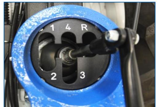
**Levier de blocage différentiel** au guidon.
