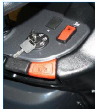
**Réglage de la hauteur de coupe par un levier à portée de main avec "memory system" doté d'une échelle graduée** qui permet de visualiser immédiatement le niveau de la hauteur de coupe (7 positions de 3 à 9,5 cm).
