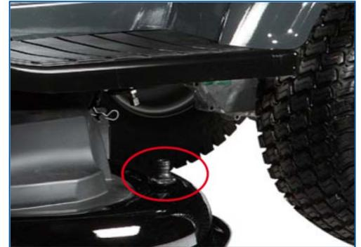
**Chargeur de batterie** (de série) pour maintenir la charge de la batterie lors du stockage hivernal : facilement accessible sans outils.
