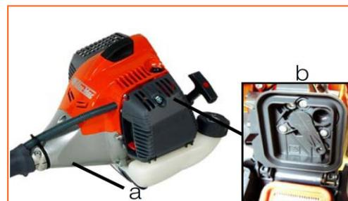
**"Primer"** accessible sur le capot supérieur, il facilite le démarrage à froid après les ravitaillements en carburant ou une longue période d'inactivité (Fig. a).
