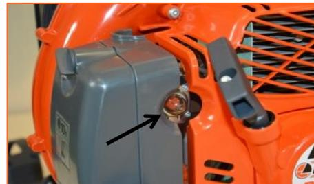
Le carburateur est équipé d'un système de régulation du mélange air/essence lorsque le filtre à air se charge en impuretés.
