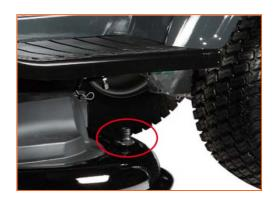
**Chargeur de batterie** (de série) pour maintenir la charge de la batterie lors du stockage hivernal : facilement accessible sans outils.
