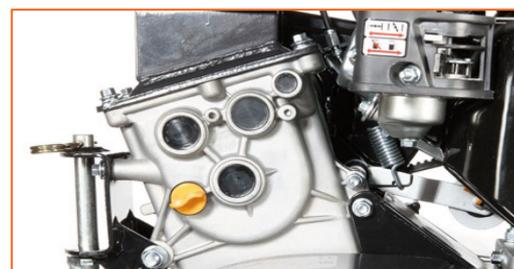
Le **filtre à air à bain d'huile** permet au moteur une meilleure résistance en milieu poussiéreux
