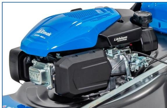
**Démarrage électrique sur batterie Lithium-ion** avec indicateur de charge (4 led).
