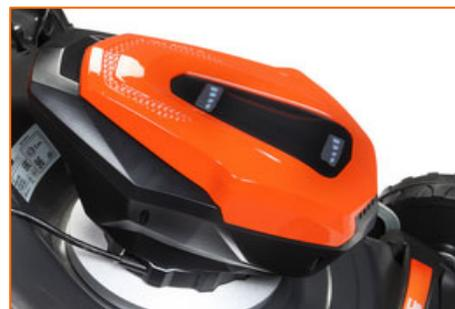
**Démarrage facile et sécurisé :** après avoir introduit la clé de sûreté dans le logement des batteries (b), il suffit de saisir le guidon et le levier rouge en les mettant au même niveau puis d'appuyer sur le bouton latéral rouge (a). Ces actions permettent d'éviter un démarrage accidentel.
